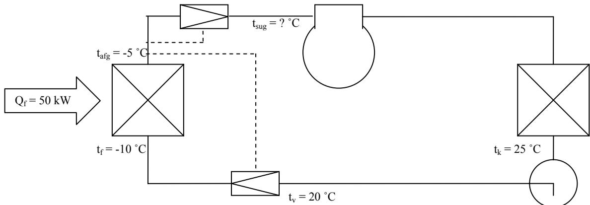
66.3 Find trykket i kompressorens sugeledning efter drøvleventilen.
